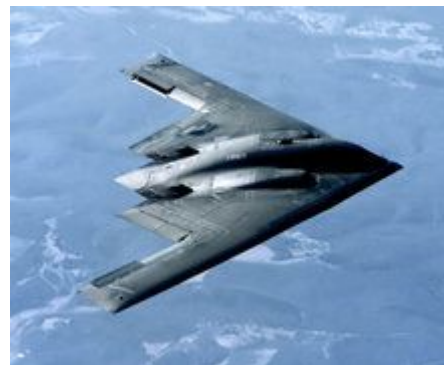
图 52. 布莱克布恩用 B-2“幽灵”隐形轰炸机作为没有尾翼的稳定飞机的例子。
